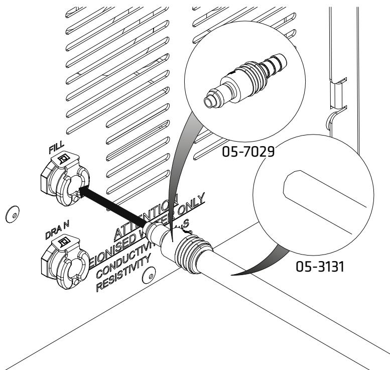
発生器の付属品キットに含まれる**タイゴンチューブ継手**は、発生器の背面にある**FILL**ポートに接続します。
