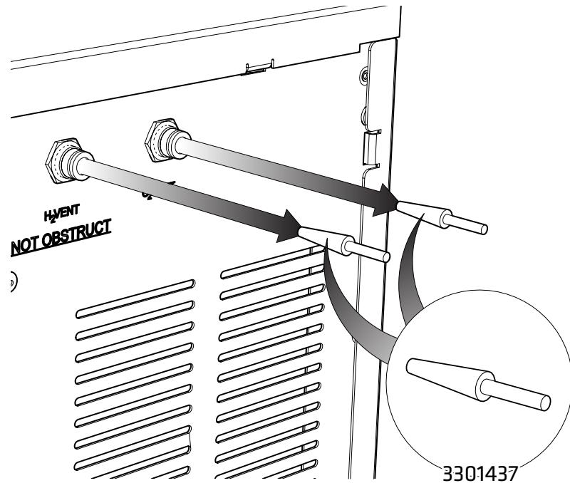
発生器の背面にある**H<sub>2</sub> VENT**ポートおよび**O<sub>2</sub> VENT**ポートから、**2本のトランジットプラグ**を取り外します。
