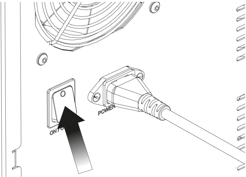
ユニットの背面にあるスイッチを使用して、発生器の電源を入れてください。
