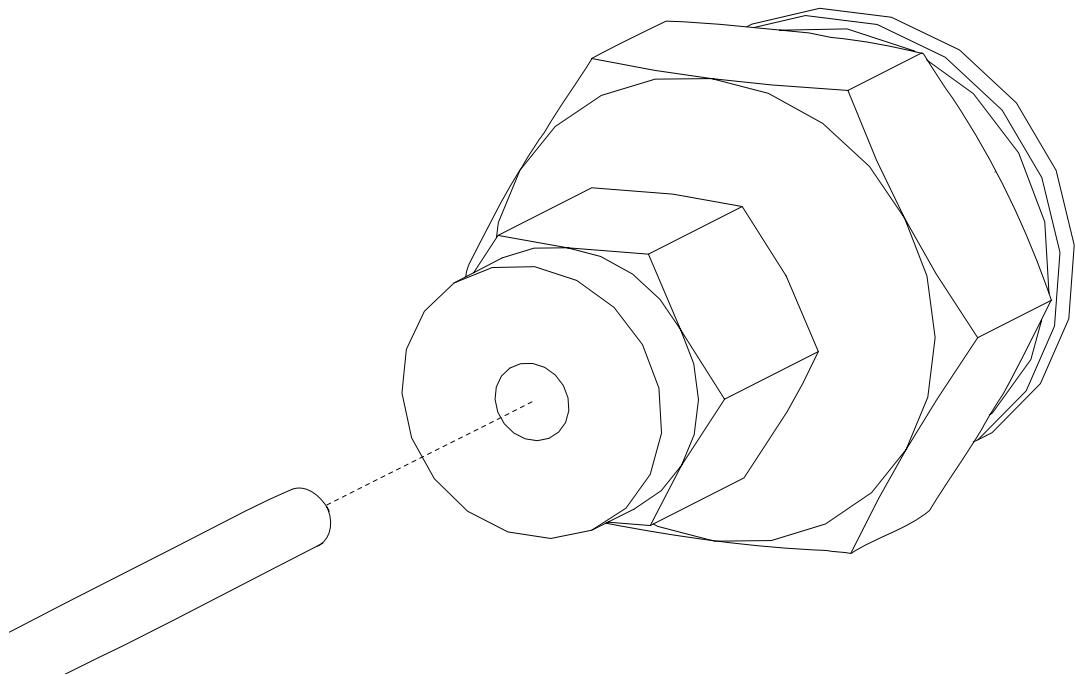
チューブの反対側を、**ガス供給先**に接続します。
