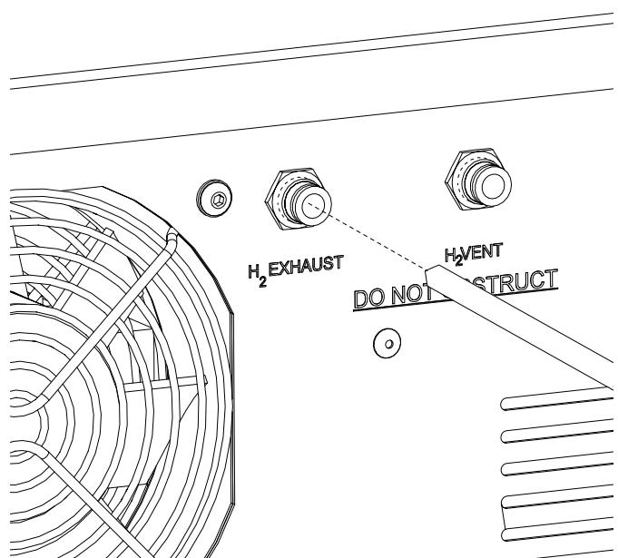
適切なチューブを**H<sub>2</sub> EXHAUST**アウトプットに接続します。Traceモデルの場合は、付属のテフロン・チューブを使用してください。
