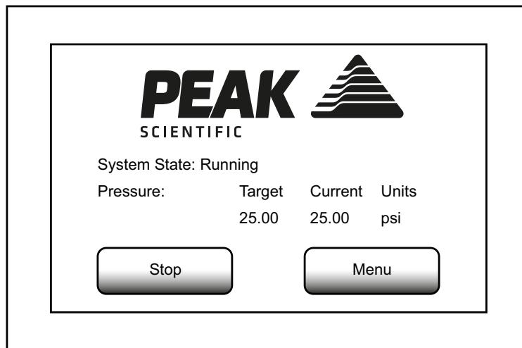
ガス供給先に対して供給しているあいだ、ユニットが必要な圧力を維持します。
