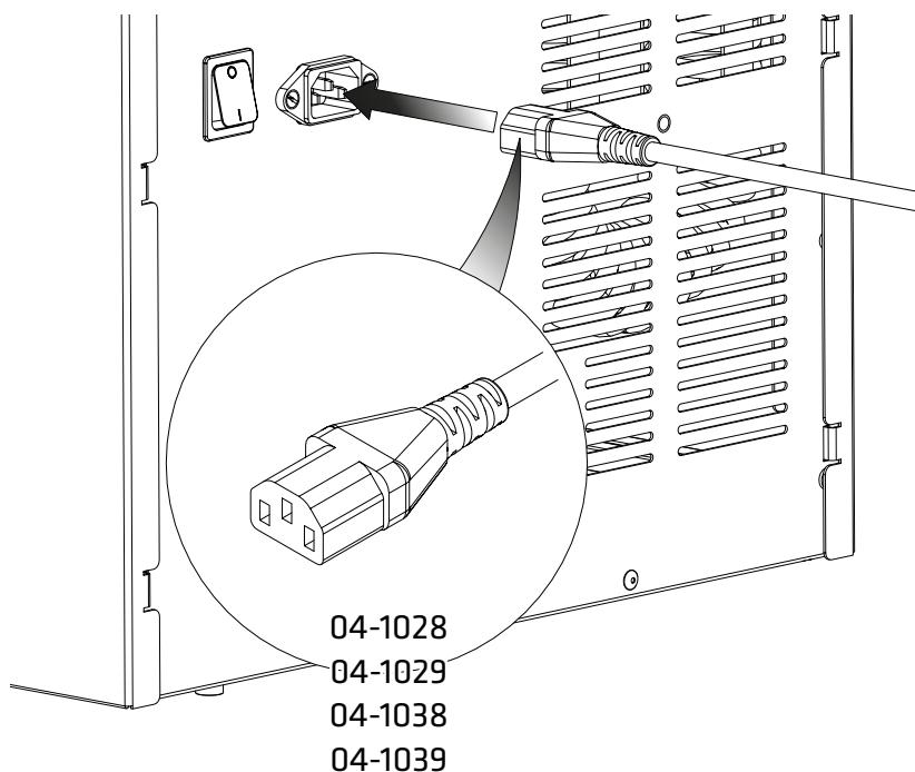
付属品キットから適切な主電源ケーブルを選択して、**IEC 60320/C13**ケーブルを発生装置の背面にある電源入力口に差し込みます。
