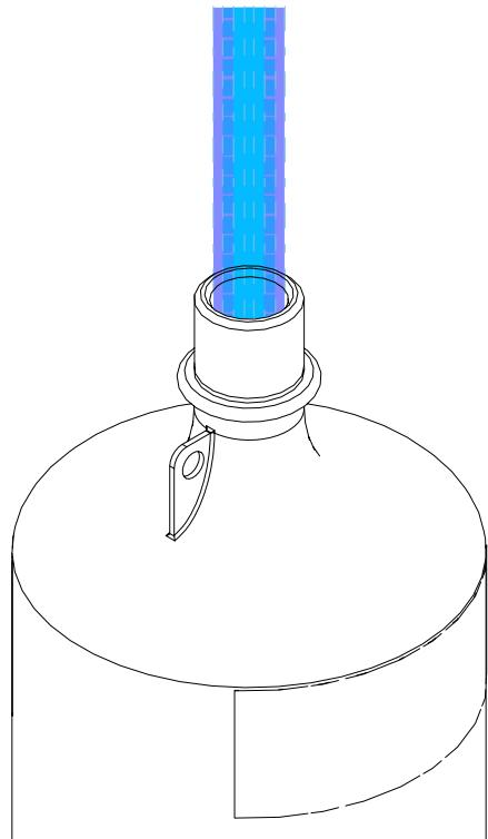
蓋を左側に回してボトルから外し、**高品質の脱イオン水**( $\leq 1 \mu\text{S}/\text{cm} @ 20^\circ\text{C}$ )で洗浄します。
