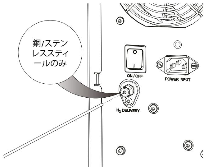
発生器の背面にある**H<sub>2</sub> DELIVERY**ポートにチューブを接続します。清潔な高品質の銅またはステンレススティールのチューブのみを使用してください。
