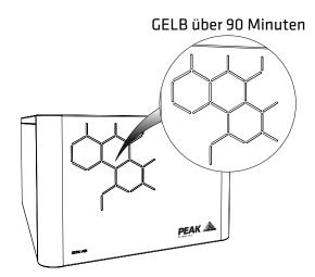
Der Generator spült Verunreinigungen aus seinem internen Lagertank, bis der Sauerstoffgehalt nach etwa 1,5 Stunden (3-3,5 Stunden bei Headspace) ununterbrochenem Betrieb bei weniger als 5 PPM liegt. Nach Abschluss dieses Vorgangs leuchtet die Blende **GRÜN** oder **BLAU** (nur Teilenummern 70-\*\*\*\*), und der Generator ist nun anschlussbereit für die Anwendung.
